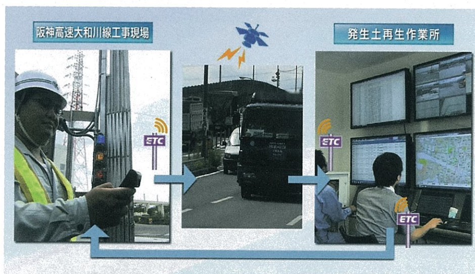
写真-1 ETC 電子マニフェスト利用状況 (排出現場の確認→運搬途中→発生土再生作業所内の中央監視室)
